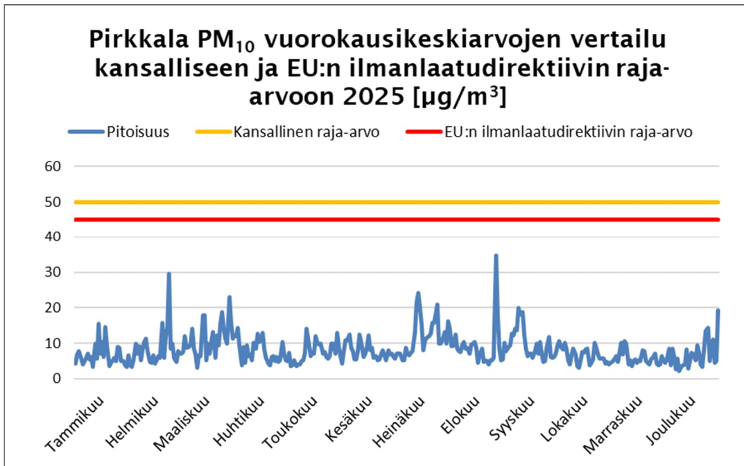
Kuvio 13. Hengitettävien hiukkasten ( \text{PM}_{10} ) vuorokausikeskiarvot Pirkkalan mittausasemalla vuonna 2025 verrattuna kansalliseen raja-arvoon 50 \mu\text{g}/\text{m}^3 ja EU:n ilmanlaatudirektiivin raja-arvoon 45 \mu\text{g}/\text{m}^3 , joka on myös WHO:n suositushjearvo. Kansallisen raja-arvon ylityksiä sallitaan 35 kpl, EU:n ilmanlaatudirektiivin raja-arvon ylityksiä 18 kpl ja WHO:n ohjearvon ylityksiä 3 kpl kalenterivuodessa. Ylityksiä ei mitattu vuonna 2025.
